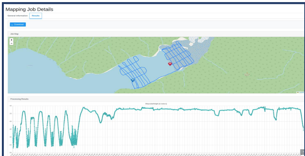
Exemples de cartes SIG produites automatiquement utilisant la hauteur ellipsoïdale
