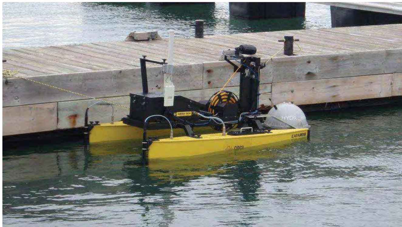
Le véhicule autonome de surface du CIDCO (Catarob) sera utilisé comme plateforme de test
